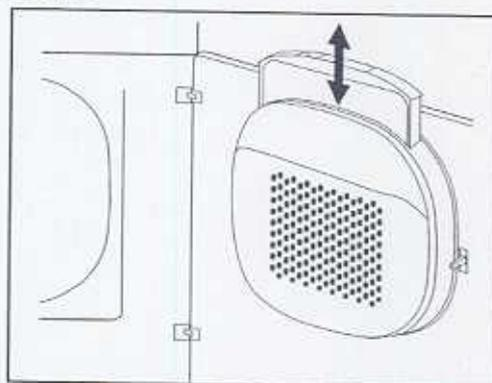
Beim Gebrauch der Wäsche entsteht Faserabrieb (Wäschevlusen), der beim Trocknen frei wird und sich im Filter an der Innenseite der Tür sammelt. Deshalb muss der Flusenfilter nach jeder Trocknung gereinigt werden.
