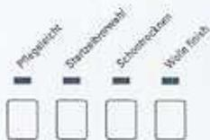
Nach der Programmwahl blinken die Kontrolllampen der Zusatzfunktionen, die bei Bedarf zugeschaltet werden können.
