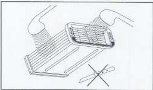
6. Luftkühler vollständig reinigen, Wasser gut abtropfen lassen.
