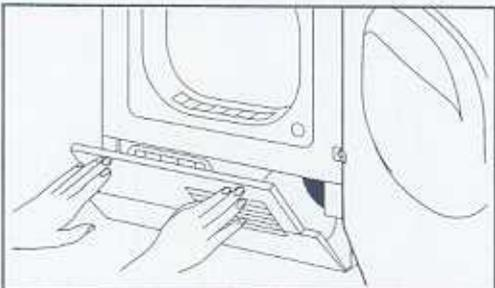
8. Wartungsklappe gleichzeitig rechts und links andrücken (siehe Abbildung), bis Verriegelung einrastet.
